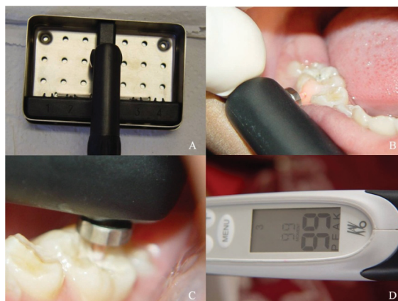
Figura 3: Exame com o aparelho DIAGNOdent pen ®. (A) Calibração do aparelho no padrão cerâmico. (B) Calibração do aparelho na superfície úmida vestibular do dente 46. (C) Ponta cilíndrica posicionada perpendicularmente à superfície oclusal. (D) Valor máximo ( peak ) indicado pelo aparelho durante o exame de varredura da superfície da lesão.
