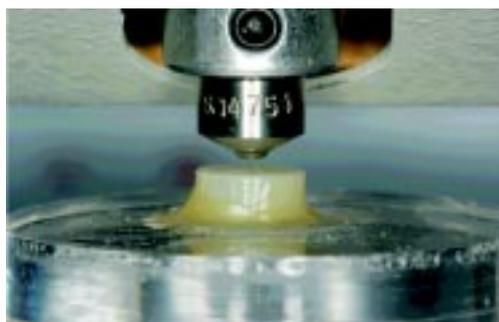
**Figura 2.** A- Microdurômetro Shimadzu; B- Vista da ponta de diamante em direção ao corpo-de-prova no teste de microdureza.
